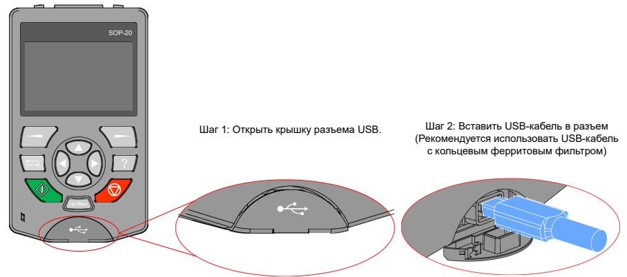
Рисунок 3-7 Порядок подключения SOP-20-880 к ПК
