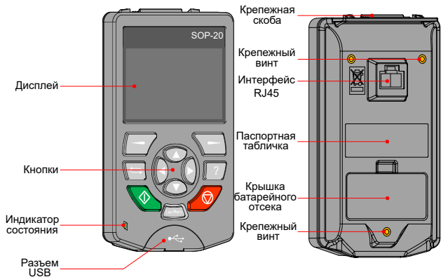
Рисунок 2-3 Комплектующие элементы панели SOP-20-880
