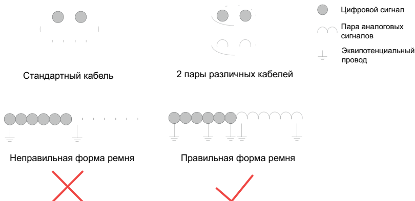
Рис. 3-3 Прокладка различных типов сигнальных кабелей
