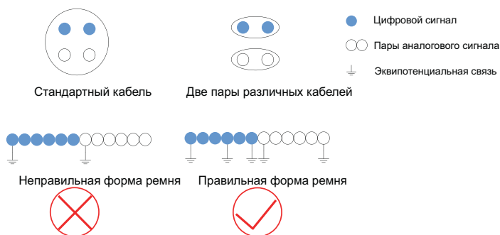
Рис. 4-3 Прокладка различных типов сигнальных кабелей
