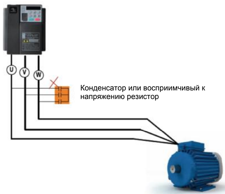
Рис. 1-2. Недопустимые подключения к выходу привода переменного тока
