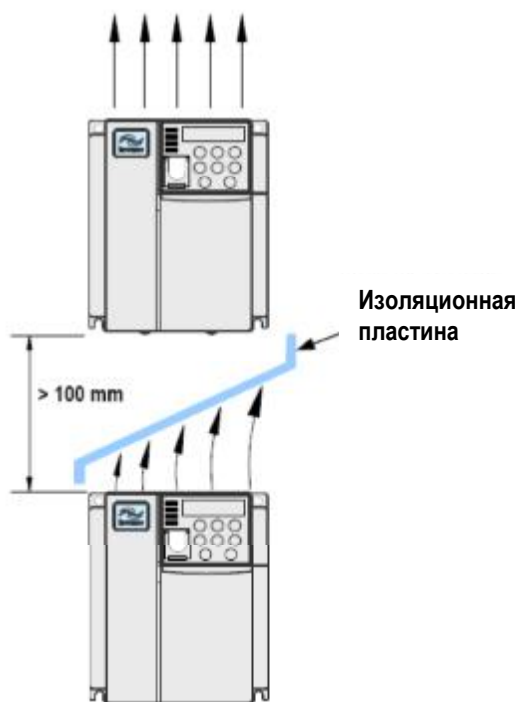
Рис. 3-2 Установка изоляционной пластины.
