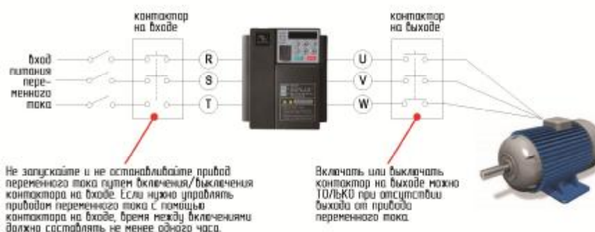
Рис. 1-3. Входные и выходные контакторы
