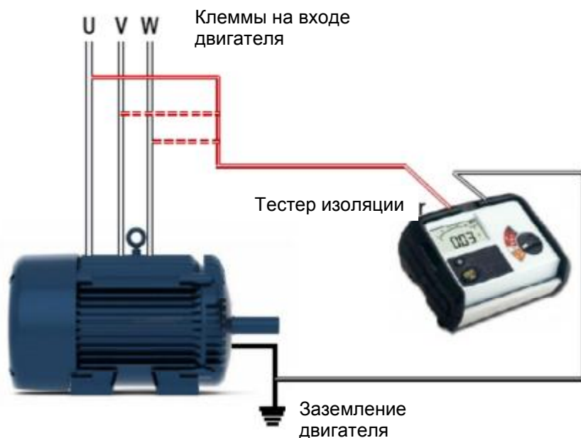
Рис. 1-1. Соединения, требуемые для проверки изоляции двигателя.
